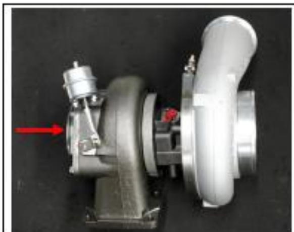
Vista lateral do turbocompressor. Único modelo, que possui flange na carcaça de turbina.
